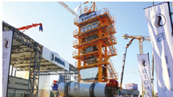
%3 agregat rutubeti esas alınarak 120 ile 320 ton/saat arası kapasitelerde plentler standart olarak üretilmektedir. SIGMA asfalt plentlerinde ön plana çıkan özellikler:
