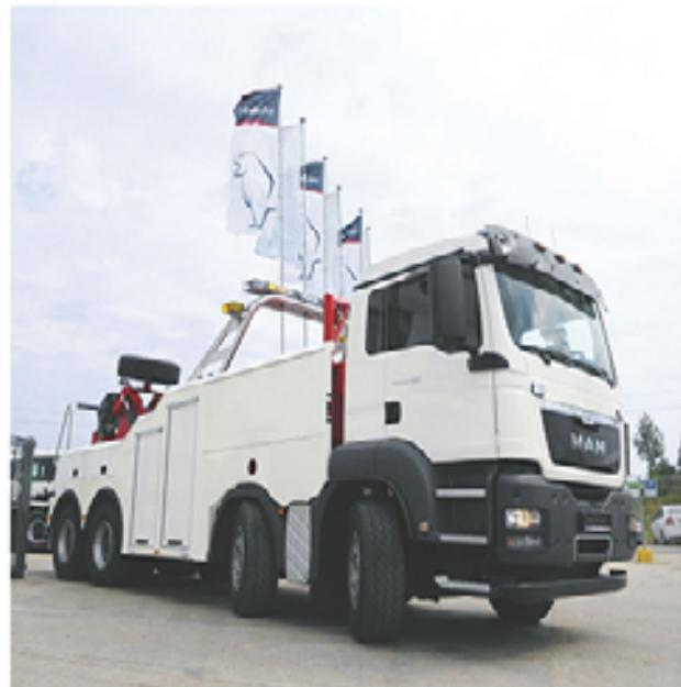
MAN TGS 8x4 Ağır Tonajlı Kurtarma Araçları ile; yerdən yüksekliği çok az olan alçak tabanlı otobüsler dahi rahatlıkla çekilebiliyor. Kamyonun arkasında bulunan özel alçak aksam, 31 tonu kaldırabilecek kapasiteye sahip. Kamyonda kullanılan kurtarma amaçlı iki çelik halatlı vincin çekme kuvvetleri de, 53 tona ulaşıyor.
