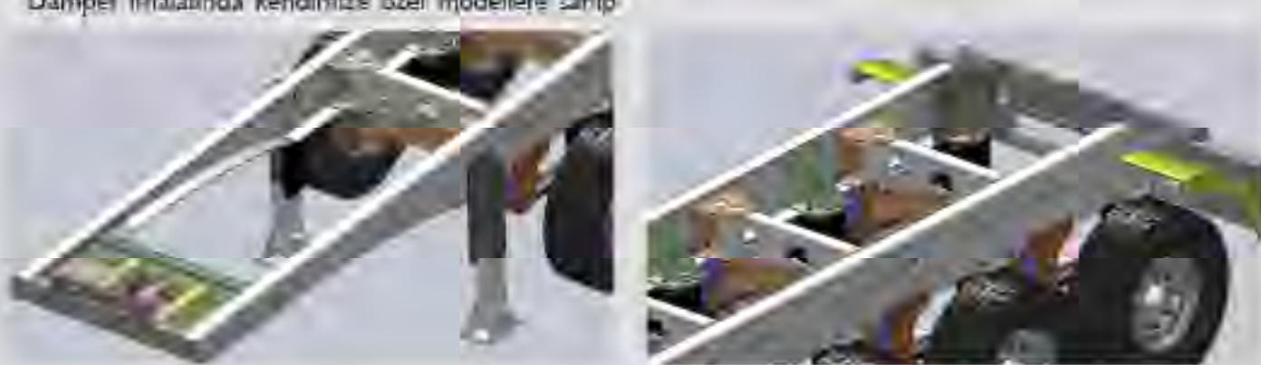
Dorse şase parçalarının tamamının kalıplarla yapılmasıdan dolayı standart ve hatasız imalat gerçekleştirilebilmektedir.
